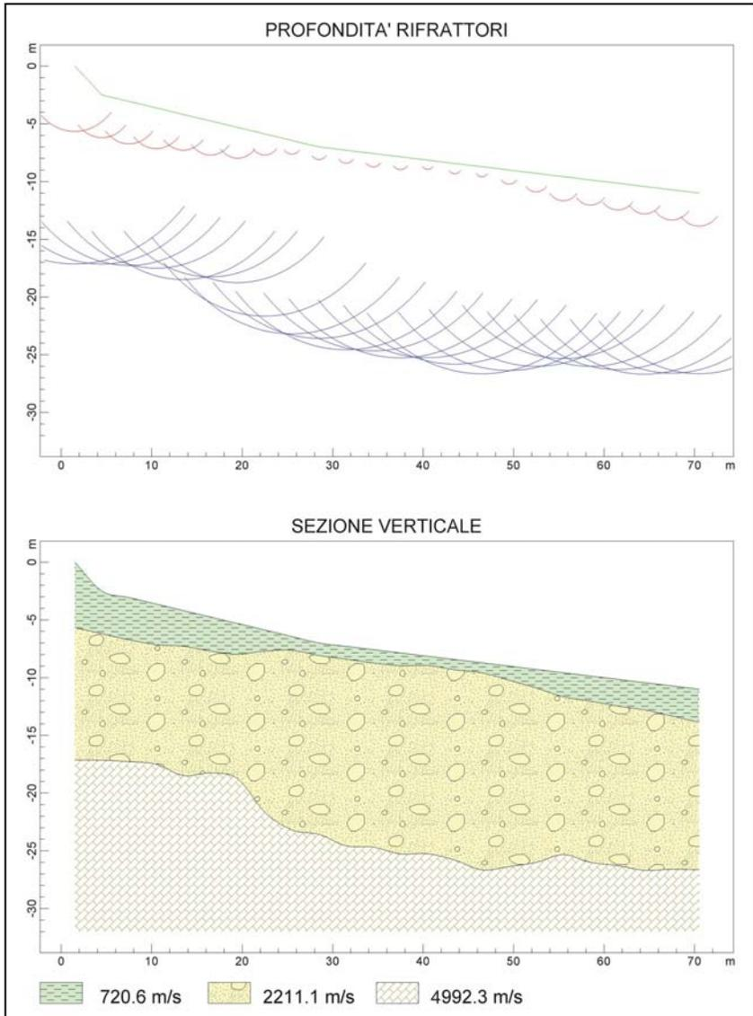
**STENDIMENTO SISMICA A RIFRAZIONE 2**
