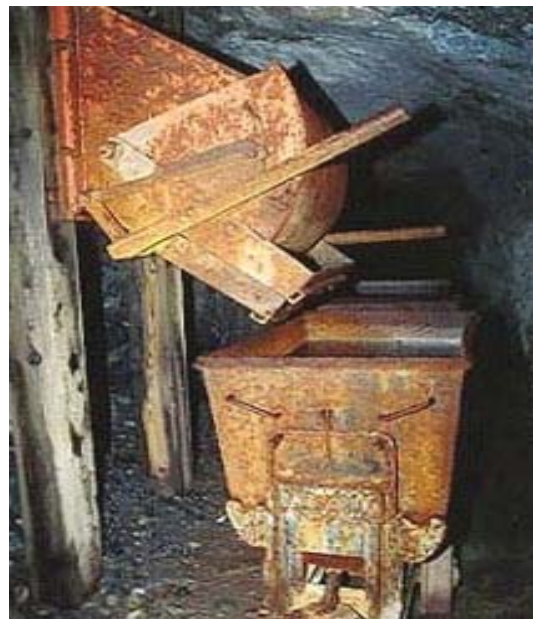
Figg. 50-51. Imbocco della discenderia e un incrocio di binari (il piatto sulla destra, fuori dalla sede originaria, era imperniato al centro dello scambio che permetteva di orientare il vagone) e vagone accostato ad una tramoggia pronto per essere riempito di minerale (foto di Bettineschi Giovanni) www.scalve.it .
