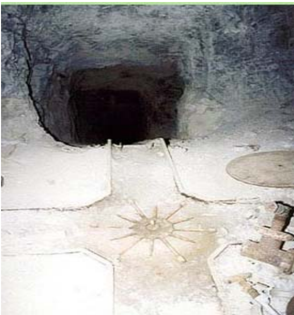
Figg. 50-51. Imbocco della discenderia e un incrocio di binari (il piatto sulla destra, fuori dalla sede originaria, era imperniato al centro dello scambio che permetteva di orientare il vagone) e vagone accostato ad una tramoggia pronto per essere riempito di minerale (foto di Bettineschi Giovanni) www.scalve.it .
