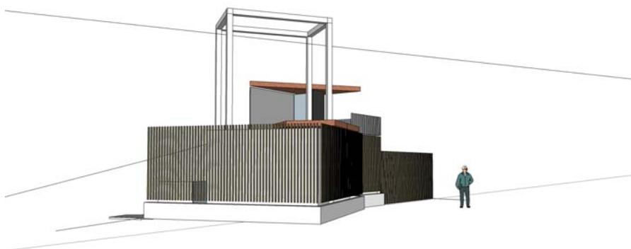
A differenza delle altre 2 stazioni, che sono inserite ai margini di aree boscate, la stazione di Villa si inserisce all'interno di un ambiente prevalentemente urbano. Valutata la particolare posizione di questa stazione, all'interno di un parcheggio di recente costruzione, si prevede di recintare gli spazi con una
