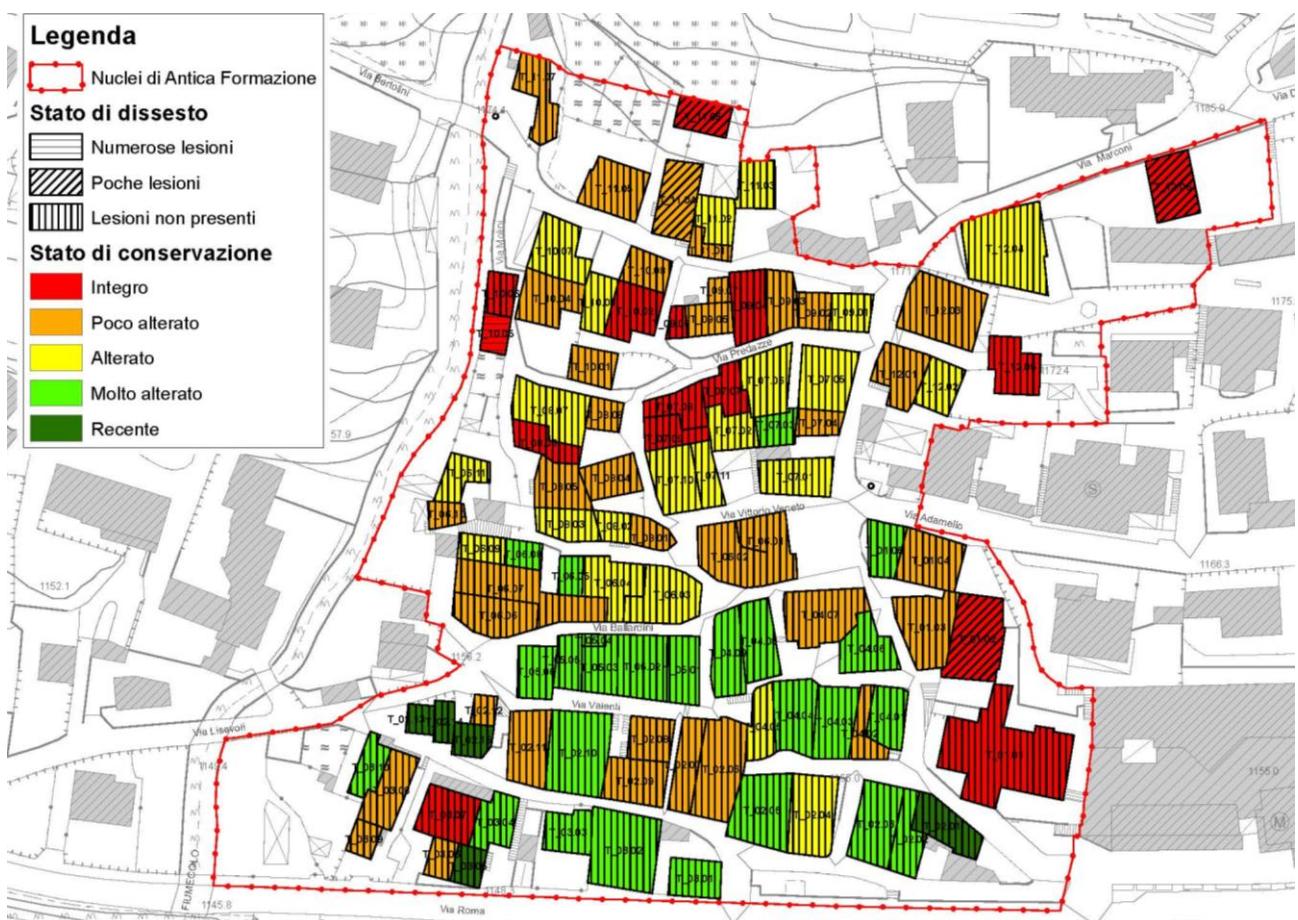
Figura 39: Schede di analisi degli edifici: restituzione dello stato di conservazione e del dissesto
