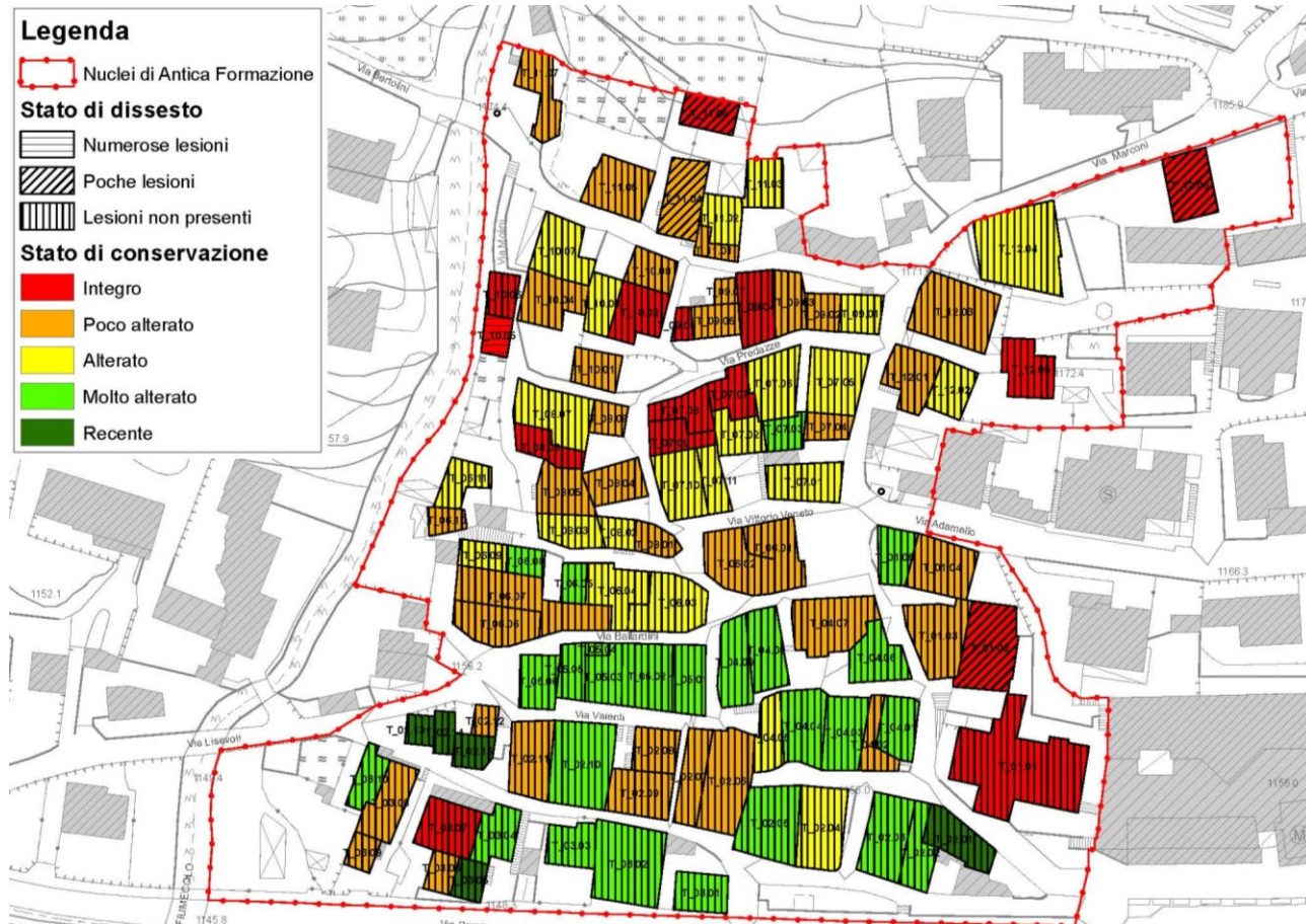
Figura 28: Schede di analisi degli edifici: restituzione dello stato di conservazione e del dissesto
