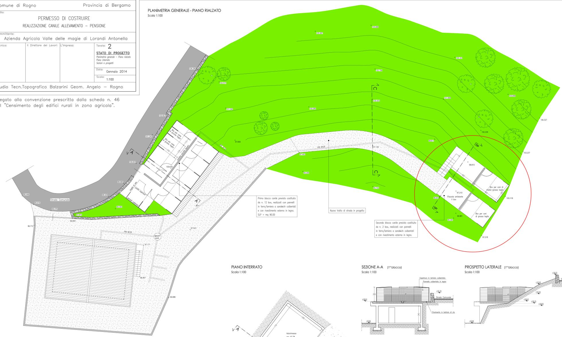
Primo blocco canile previsto costituito da n. 12 box, realizzati con pannelli in ferro/lamiera o sandwich coibentati e con rivestimento esterno in legno. SLP = mq 90,00
