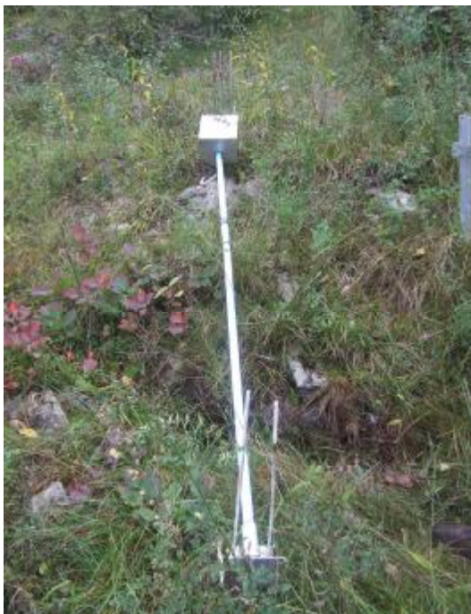
Figura 16 Monitoraggio estensimetrico di uno dei sistemi di tension crack
