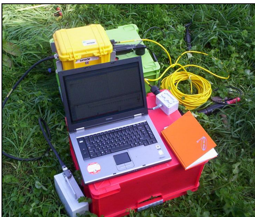
Figura 1: Strumentazione utilizzata per la prova MASW.
