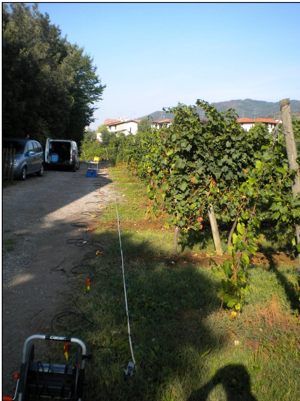
Figura 4: Area M11- vista dello stendimento MASW11.
