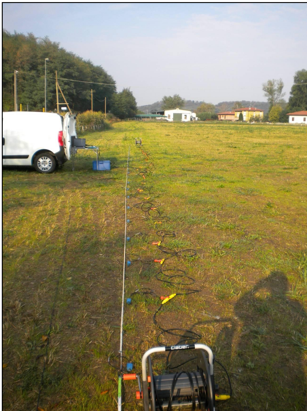
Figura 2: Area M1 - vista dello stendimento MASW1.
