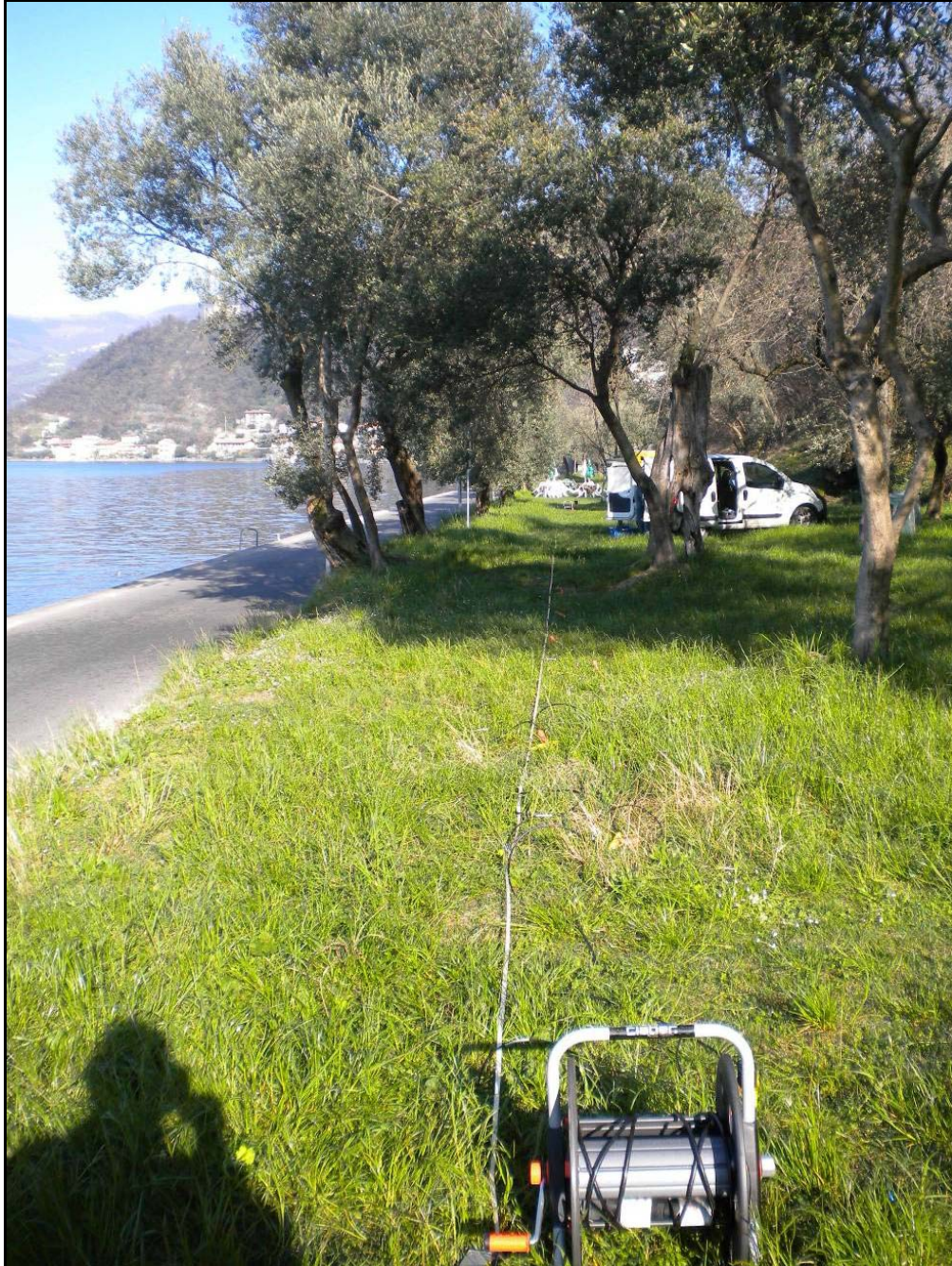
Figura 2: Area1 - vista dello stendimento MASW1.
