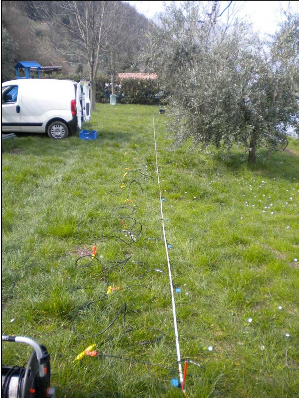
Figura 5: Area 4- vista dello stendimento MASW4.
