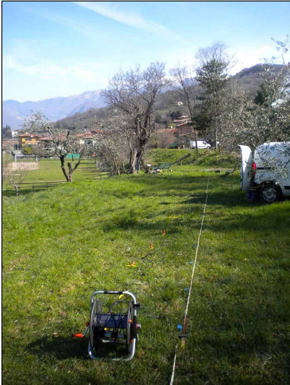
Figura 3: Area 2- vista dello stendimento MASW2.
