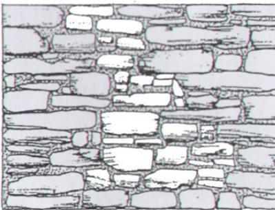
Utilizzare malta di calce e sabbia per la formazione dei giunti, ripulendo in profondità le connessioni e le pietre da porre in opera.
