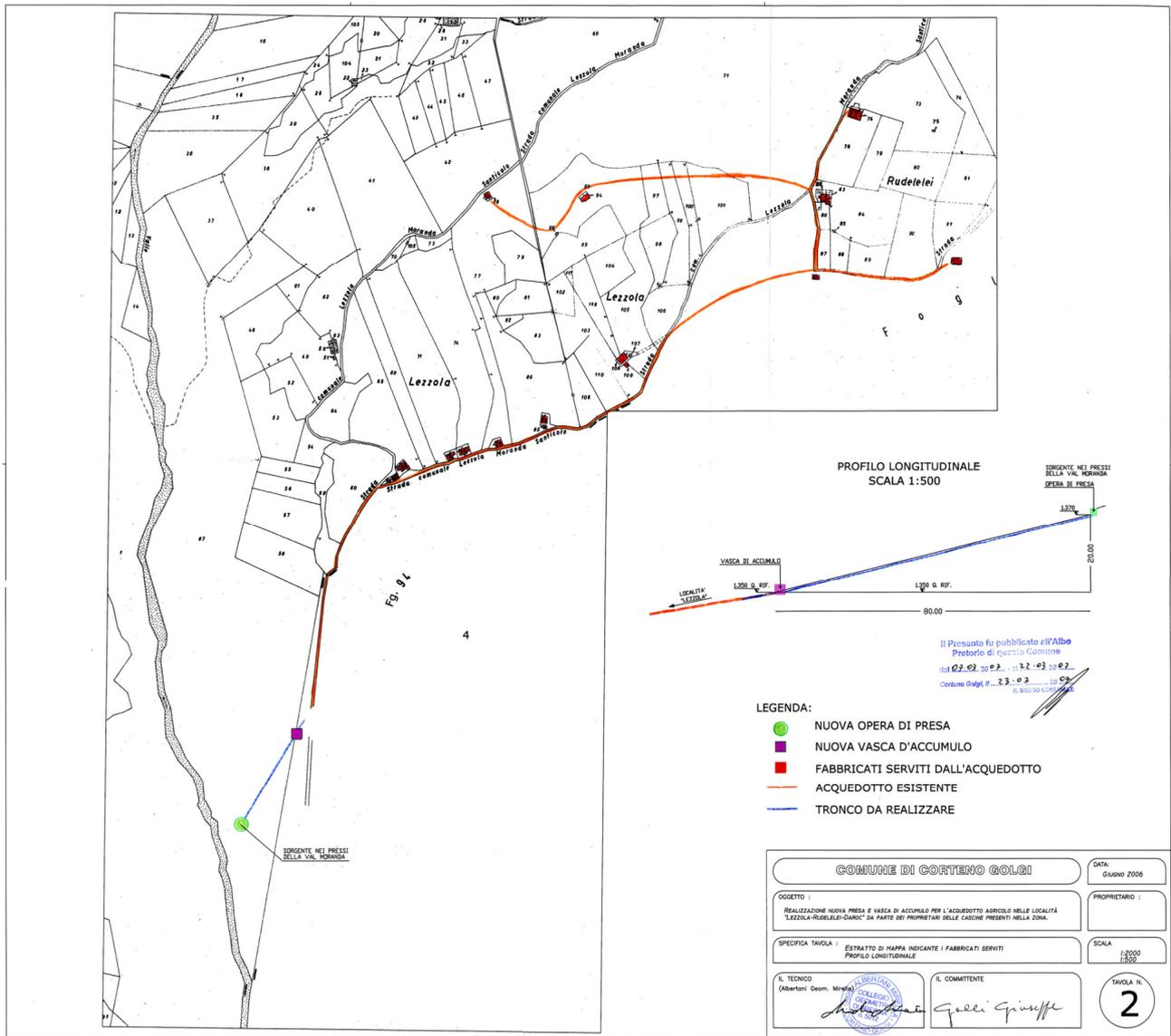
*Realizzazione nuova presa e vasca di accumulo per l'acquedotto agricolo nelle località "Lezzola-Rudelelei-Daroc" da parte dei proprietari delle casine presenti nella zona. Estratto di mappa indicante i fabbricati serviti, profilo longitudinale. Giugno 2006*
