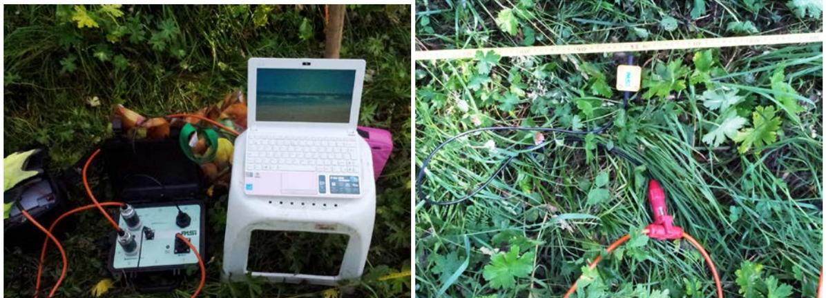
**Foto 3 e 4:** strumento di registrazione e geofono
