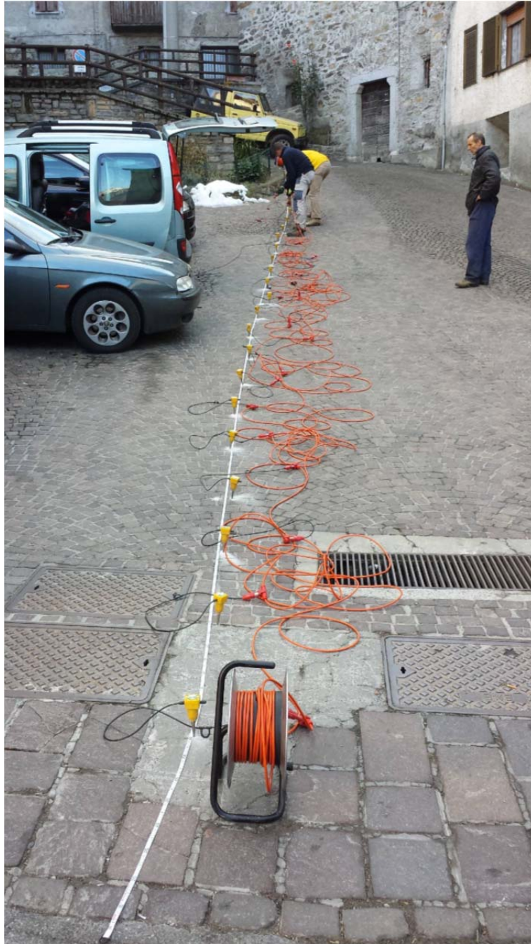
Foto 1: MASW 1 presso piazzetta del municipio
