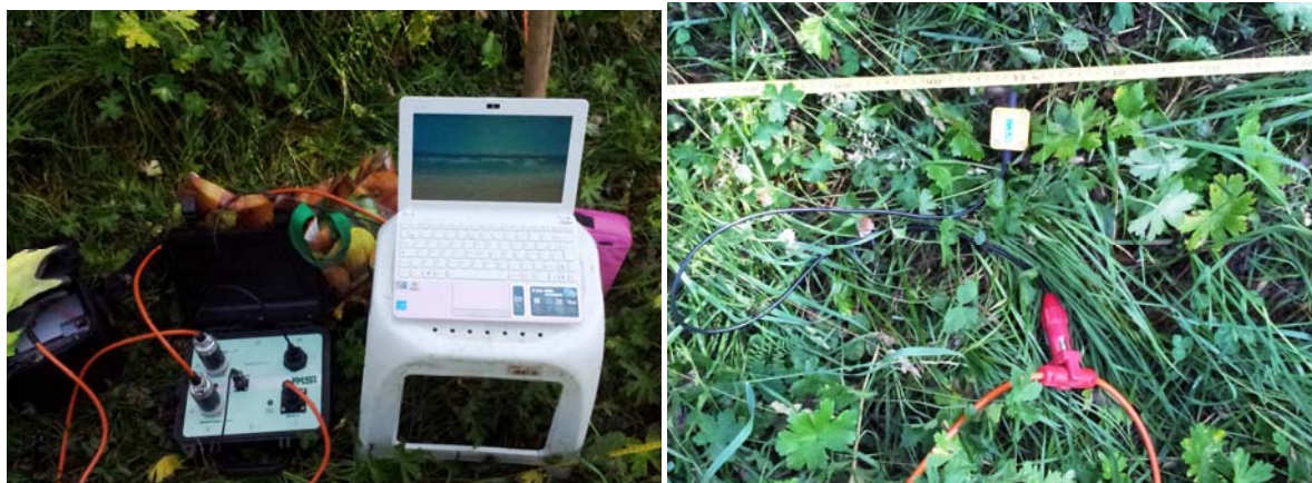
Foto 3 e 4: strumento di registrazione e geofono
