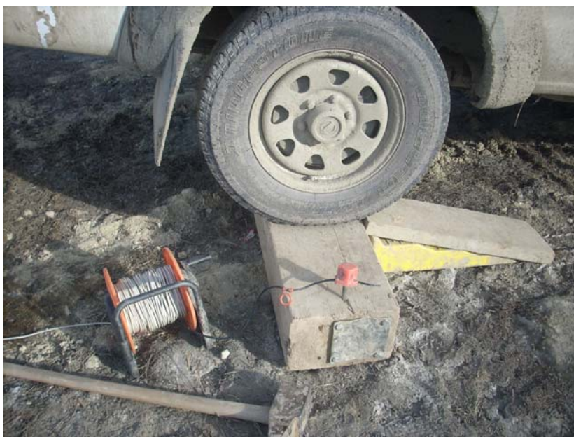
Figura 2 Evidenza del punto di energizzazione con onde S
