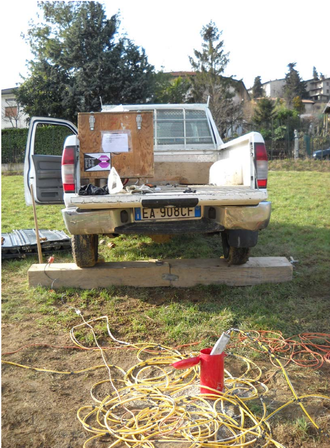
Figura 3 Foro predisposto per indagine Down-hole
