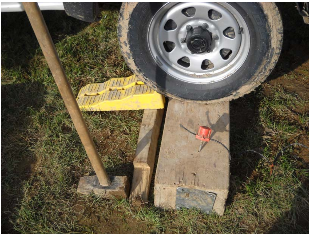
Figura 2 Trave per energizzazione con massa battente
