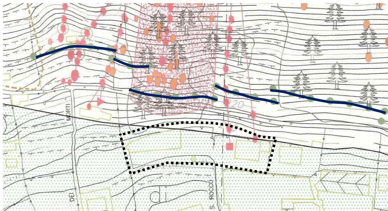
Figura 32 - Carta Geomorfológica di analisi del dissesto, stralcio con evidenziata l'ubicazione delle barriere paramassi esistenti al 2005 e con tratteggio l'area oggetto di verifica per la ridelimitazione della classe di fattibilità geologica (su base GeoTer 2005)
