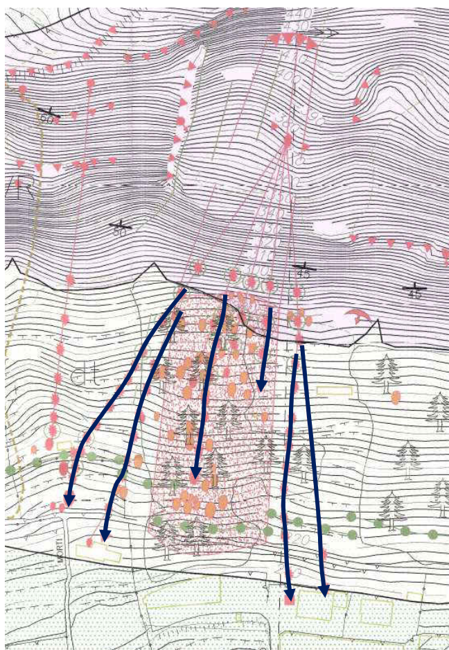
Figura 31 - Area della frana dell'agosto 2002. Si evidenziano le principali traiettorie di caduta (da GeoTer-Berdini, 2005)
