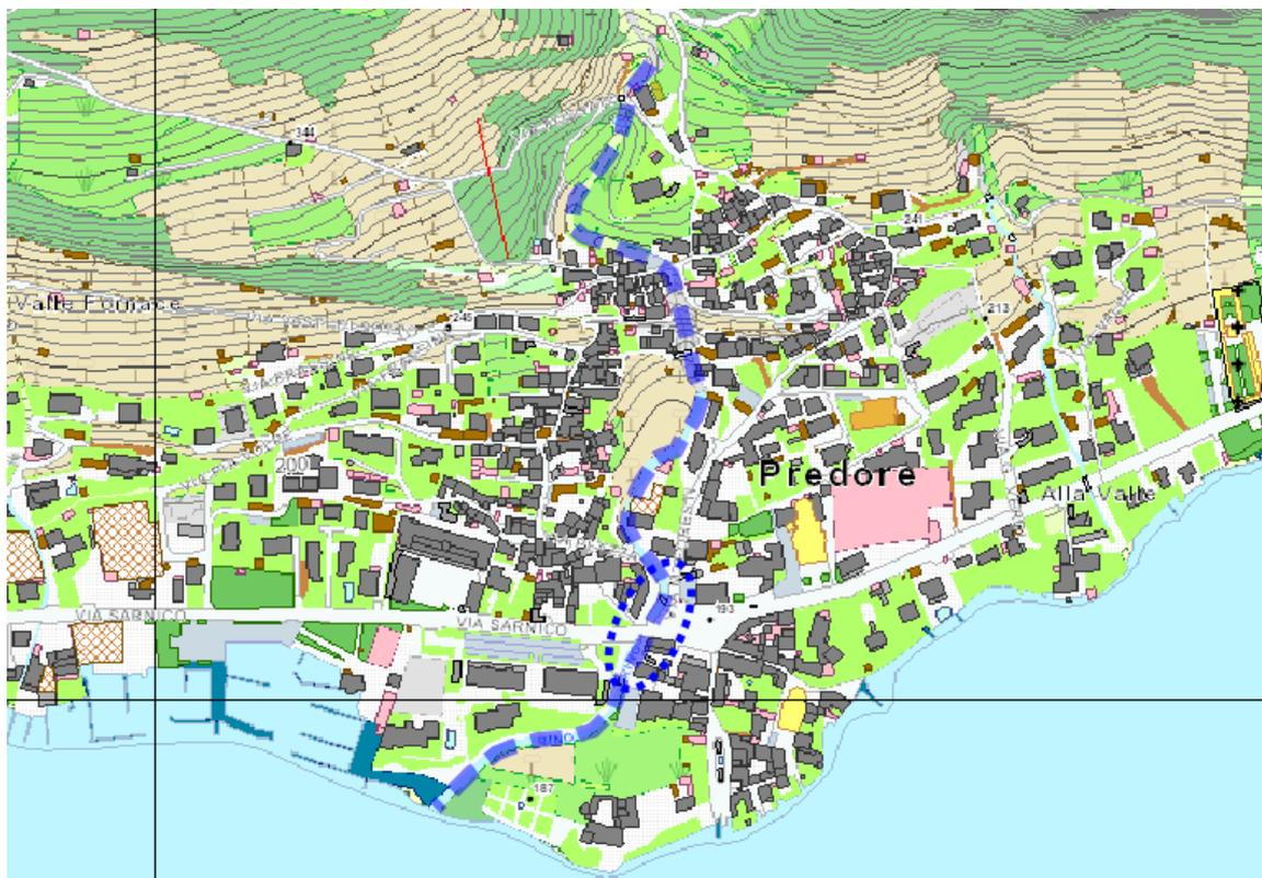
Figura 60 - Tratto a forte criticità idraulica lungo l'alveo del torrente Rino e aree contermini in area urbana. Si indica la posizione della maggiore e più critica concentrazione degli attraversamenti.
