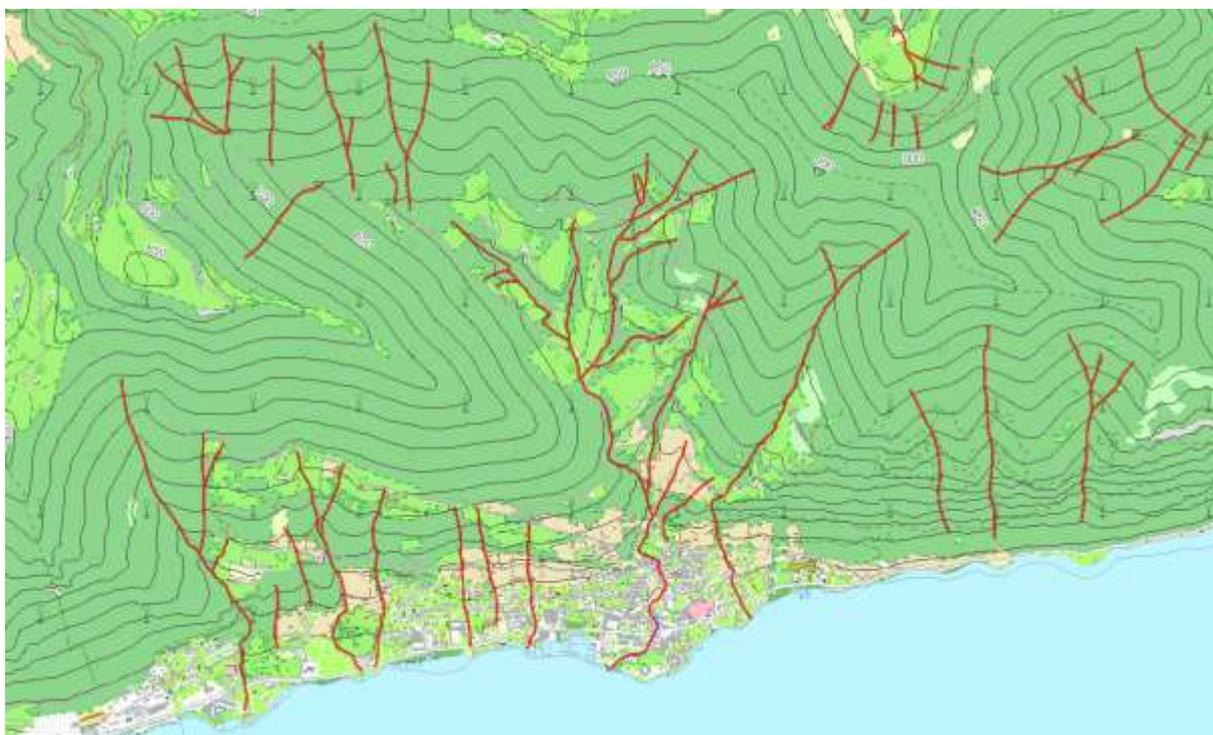
Figura 64 - Rappresentazione del reticolo minore dove si segnalano, anche solo localmente, situazioni di erosioni, occlusioni o scarsa manutenzione dell'alveo (v. anche foto 21)
