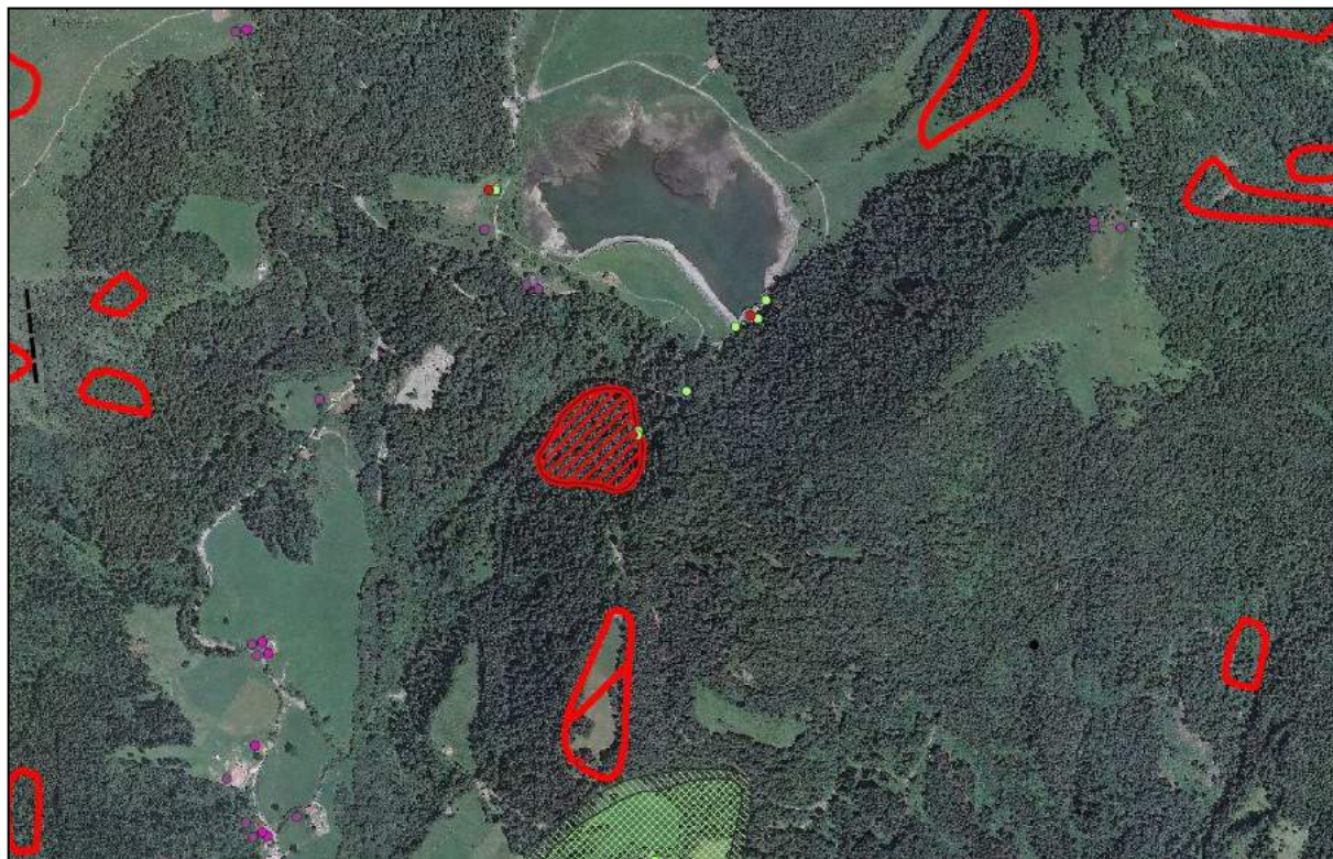
Figura 24 – Mire di interferometria con sovrapposte le aree censite nel GeoIFFI (contornate in rosso), del P.A.I. Originario (verde) e l'area di studio (barrato rosso)
